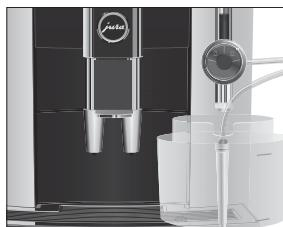
**i** Для правильного під'єднання молочного шланга до контейнера молочний шланг повинен бути оснащений сполучною деталлю.
